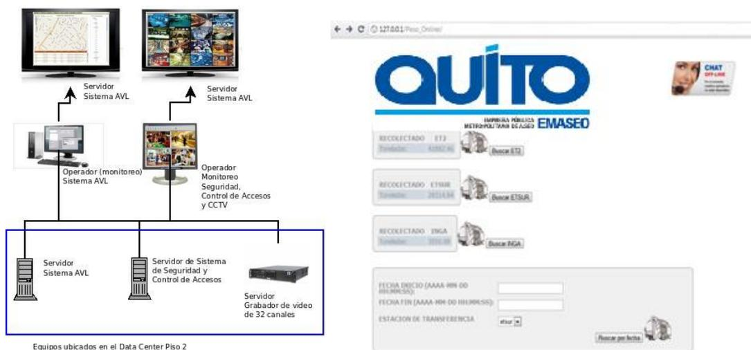
**Figura 14. Esquema de los servicios instalados y operativos en el Centro de Control de Operaciones de La Occidental**
