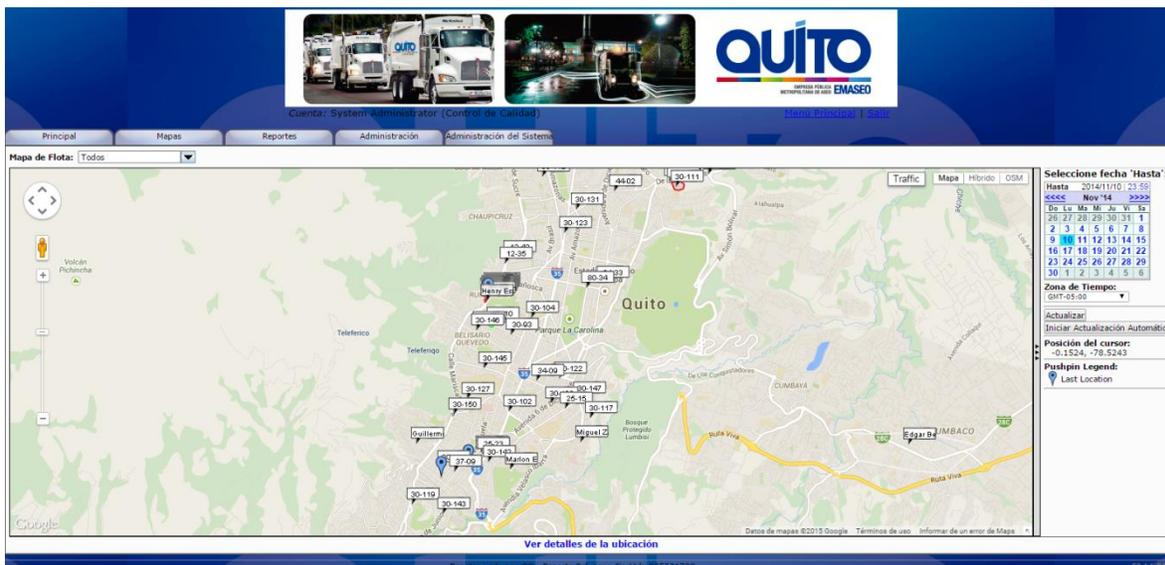
**Figura 15. Visor Web del Sistema de Monitoreo de Flota Vehicular Satelital mediante el cual es posible conocer el comportamiento de las unidades de recolección durante la prestación de servicios**
